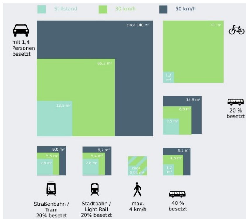
Abbildung 64: Vergleich der Flächeninanspruchnahme durch Pkw, Bus, Straßenbahn, Stadtbahn, Radfahrer und Fußgänger pro Kopf ( www.zukunft-mobilitaet.net ; Light Rail Icon: Scott de Jonge CC BY 3.0).
